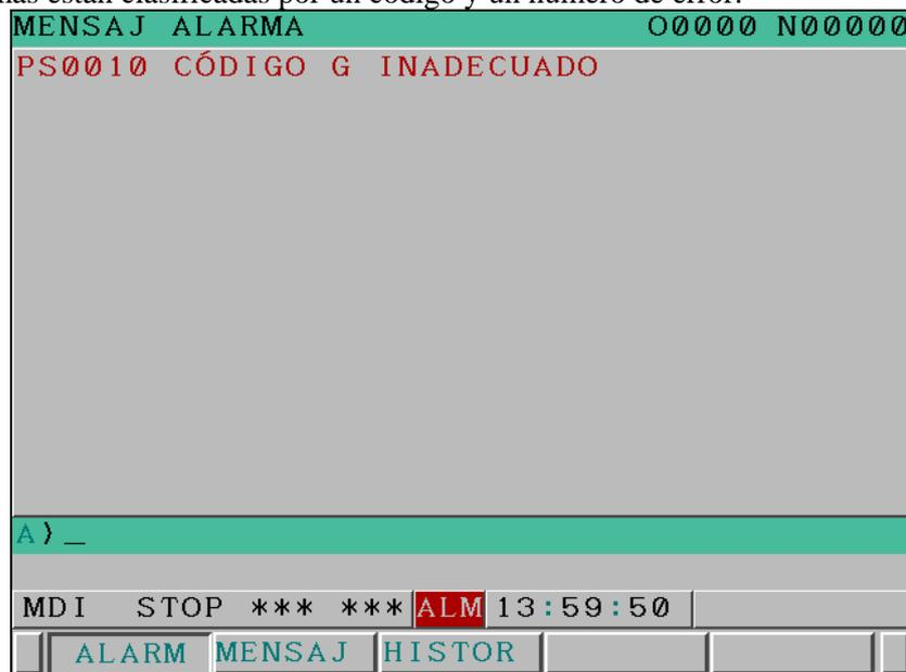
Fig. 7.1 () Pantalla de alarmas (ejemplo para la unidad de visualización de 8,4")
