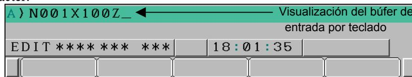
Fig. 2.3.4 (a) Visualización del búfer de entrada por teclado
