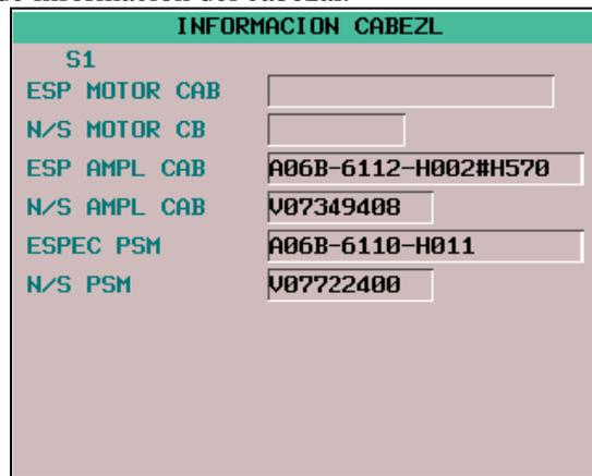
Fig. 12.4.12 (e) Pantalla de información del cabezal
