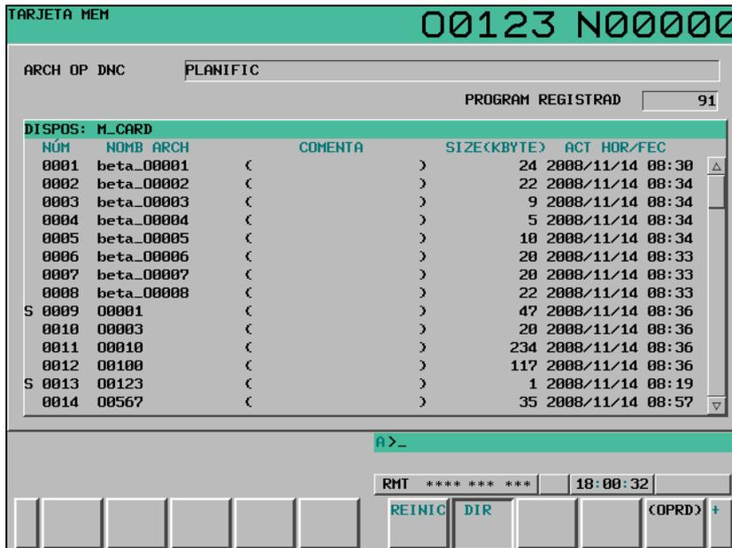
Fig. 4.4 (g) Pantalla de lista de programas (tras ajustar los datos de planificación) (pantallas de 10,4")
