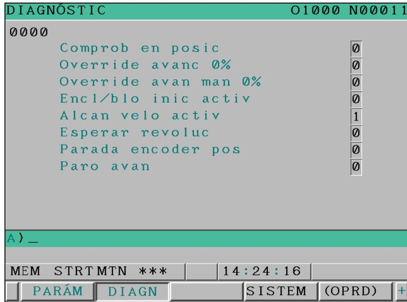
Fig. 7.3 (a) Visualización del diagnóstico (ejemplo para la pantalla de 8,4")
