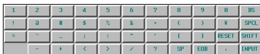
Figura 14.1 (d) Parte superior de las teclas en el estado de mayúsculas
