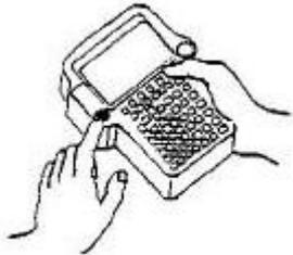
Girar el interruptor **ON/OFF** del TP a la posición de ON.
