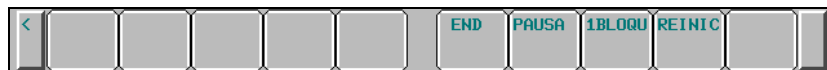
Fig. 13.2.1.2 (r) Teclas de pantalla visualizadas durante la ejecución del gráfico (LCD de 10,4")
