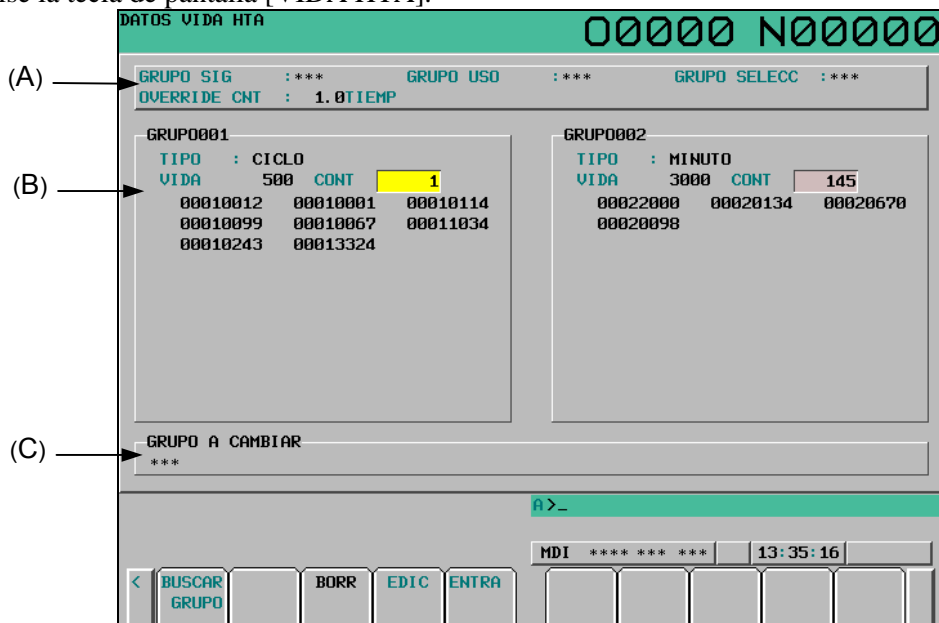
Fig. 12.3.11.1 (a) Visualización de la gestión de vida de herramienta (pantalla de lista) (10,4")
