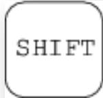
La tecla Shift se utiliza para activar los motores del robot junto con el DEAD MAN cuando se desea moverlo, también en conjunto con las teclas que están en azul para activar una segunda función.
