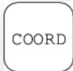
La tecla Coord se utiliza para cambiar de sistema de coordenadas en la cual se desea trabajar, *JOINT*, *JGFRM*, *World frame*, *TOOL*, *USER*.
