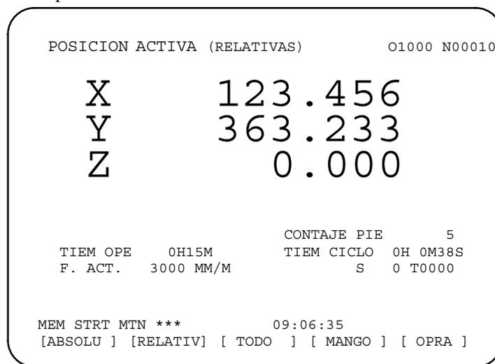
El número de piezas mecanizadas (CONTAJE PIE), el tiempo de funcionamiento (TIEM OPE) y el tiempo de ciclo (TIEM CICLO) se visualizan debajo de la posición actual.
