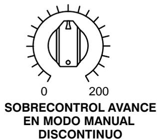
Coloque el selector de sobrecontrol del avance en el porcentaje deseado (%) en el panel del operador de la máquina antes o durante el funcionamiento automático.
