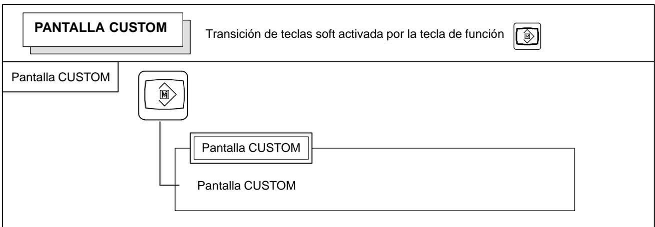
La disposición de la pantalla CUSTOM la personaliza el fabricante de la máquina-herramienta. Para más detalles sobre esta pantalla, consulte el manual publicado por el fabricante de la máquina-herramienta. Para cambiar de la pantalla CUSTOM a otra pantalla, pulse la tecla de función deseada.
